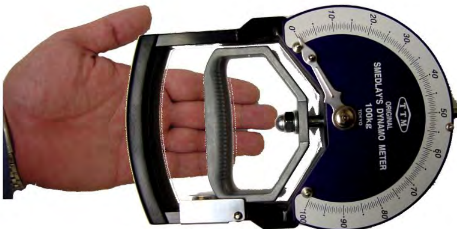
Abbildung GS-3: Metallgriff des Handkraftmessers am zweiten Fingerglied während des Greifens
